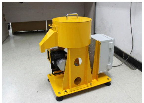
<사투 생산 효율 증대를 위한 적정기술 프로젝트 수행, 사투 생산과정 및 사투 콩 탈피기>
